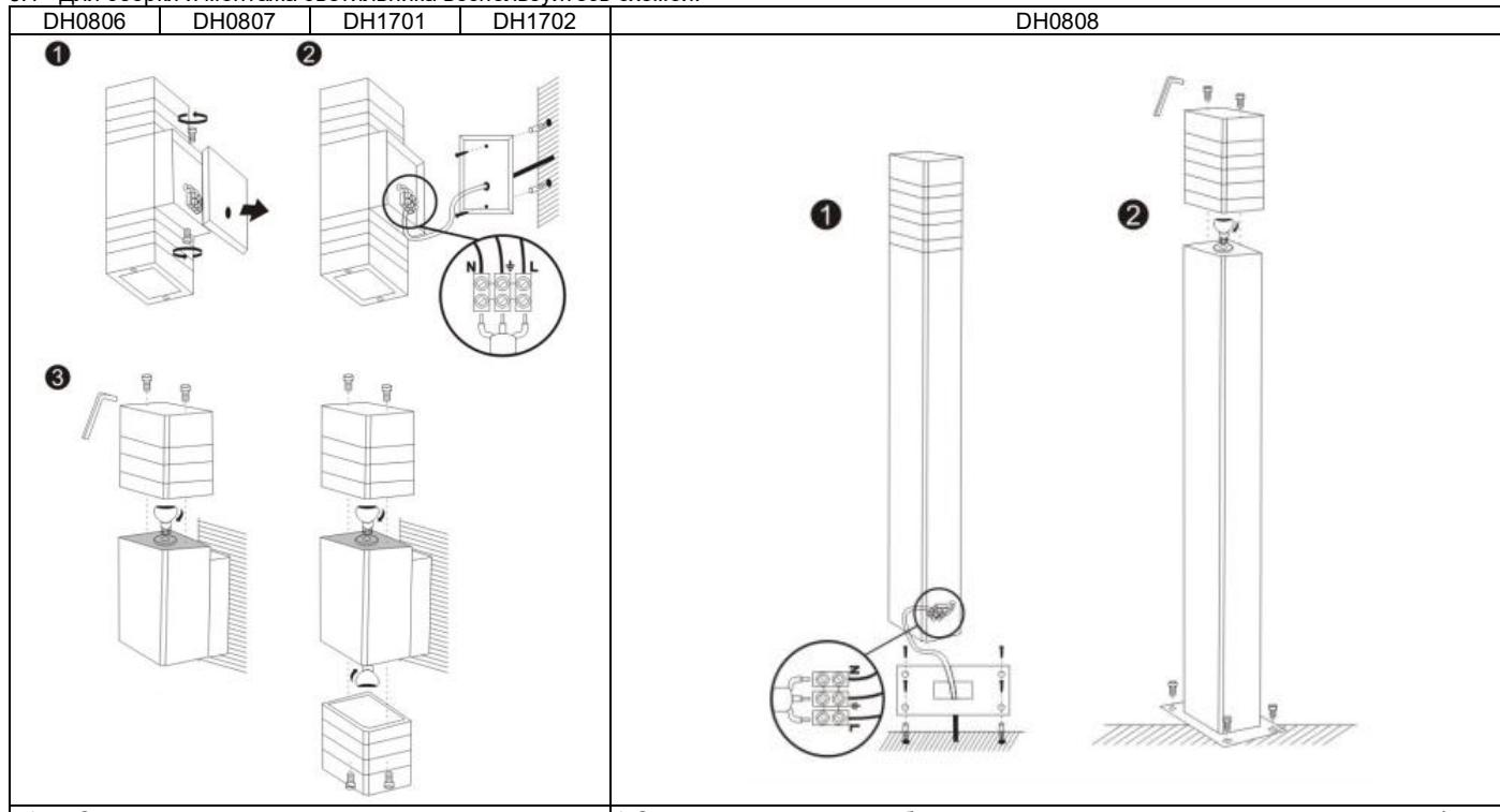
1. Снимите основание светильника, выкрутив сбоку два удерживающих винта.
