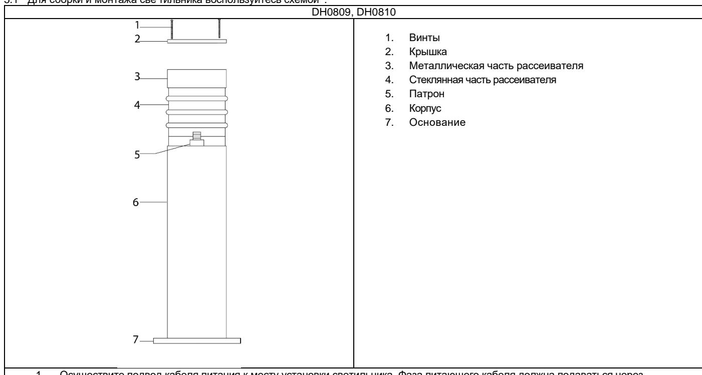
2. Чтобы обеспечить хорошую устойчивость светильника, предусмотрите бетонный фундамент глубиной в 30см. Выведите питающий кабель через центр основания монтажной поверхности. Присоедините сетевые провода к сетевым зажимам светильника при помощи клеммной колодки.
