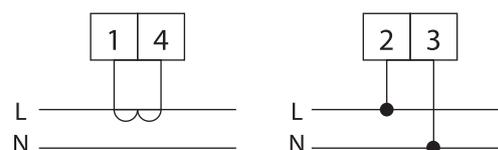
Включение в измерительную цепь амперметров А45Д через трансформатор тока (слева) и вольтметр В45Д (справа).
