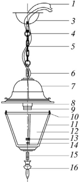
1 – провод заземления; 2 – провода питания; 3 – чаша для крепления; 4 – крепежное кольцо; 5 – цепь подвеса; 6 – малое резьбовое крепление; 7 – верхняя крышка; 8 – ламподержатель; 9 – патрон; 10 – винты; 11 – каркас; 12 – стеклянный рассеиватель; 13 – гайка; 14 – гровер; 15 – большое резьбовое крепление; 16 – балысина.
