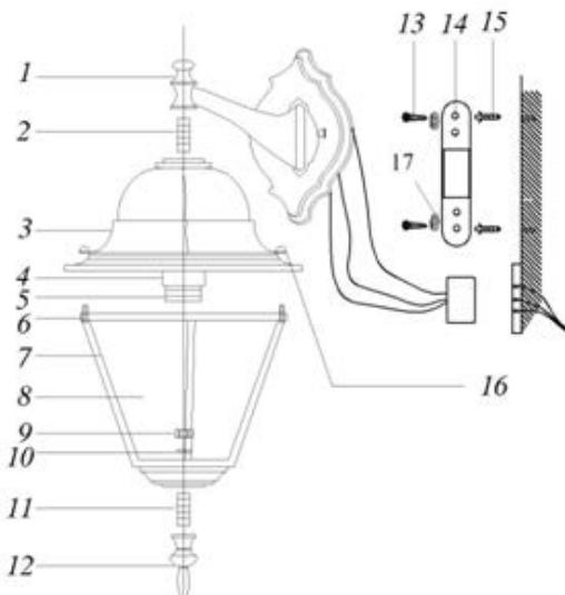
1 – балюсина; 2 – малое резьбовое крепление; 3 – крышка; 4 – ламподержатель; 5 – патрон; 6 – винты; 7 – каркас; 8 – стеклянный рассеиватель; 9 – гайка; 10 – гровер; 11 – большое резьбовое крепление; 12 – основание; 13 – саморезы; 14 – крепежная скоба; 15 – фиксаторы саморезов; 16 – шайба.
