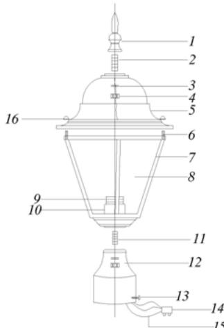
1 – балюсина; 2 – резьбовое крепление; 3 – гровер; 4 – гайка; 5 – верхняя крышка; 6 – винты; 7 – каркас; 8 – стеклянный рассеиватель; 9 – патрон; 10 – ламподержатель; 11 – резьбовое крепление; 12 – постамент; 13 – винт; 14 – клеммник; 15 – провод защитного заземления; 16 – декоративная гайка.
