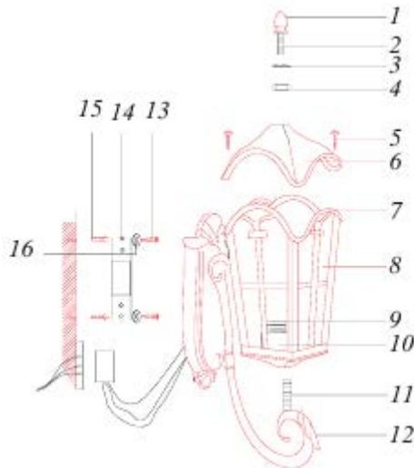
1 – балюсина; 2 – полое винтовое крепление; 3 – гровер; 4 – гайка; 5 – винты;
