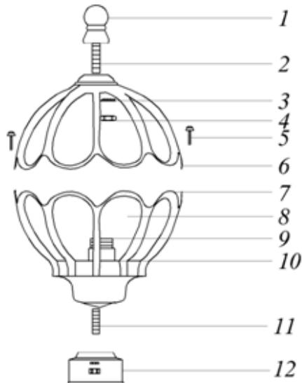
1 – балюсина; 2 – резьбовое крепление; 3 – гровер; 4 – гайка; 5 – винты; 6 – верхняя крышка; 7 – нижняя крышка; 8 – рассеиватель; 9 – патрон; 10 – ламподержатель; 11 – резьбовое крепление; 12 – основание.
