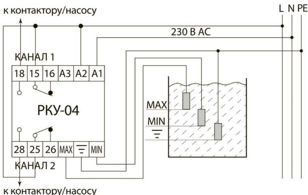
Рисунок 9. Схема подключения РКУ-04 к электрической сети
