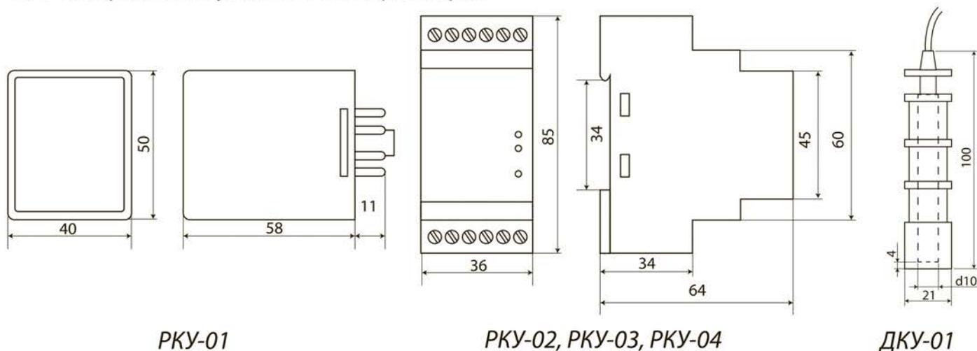
Рисунок 2. Габаритные и установочные реле, мм
