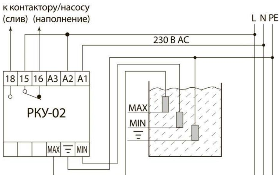
Рисунок 4. Схема подключения РКУ-02 к сети
