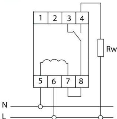
Рисунок 4. Схема подключения ограничителя мощности ОМ-3 к сети (при нагрузке более 2 кВА с использованием контактора)
