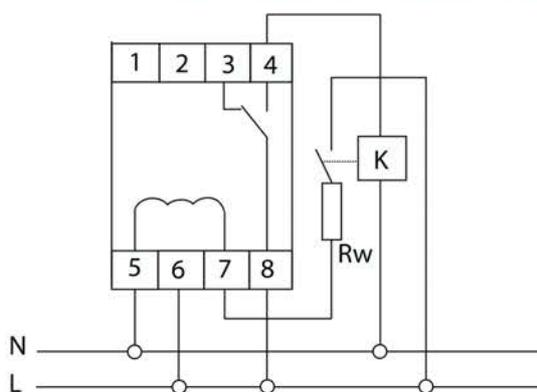
Рисунок 5. Схема подключения ОМ-611 к сети
