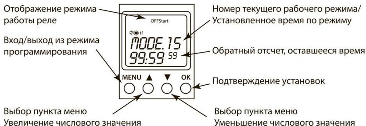
Рисунок 4. Показания дисплея и управляющие элементы реле
