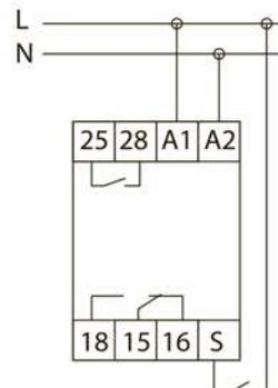
Рисунок 2. Схема подключения реле РВМЦ к электрической сети
