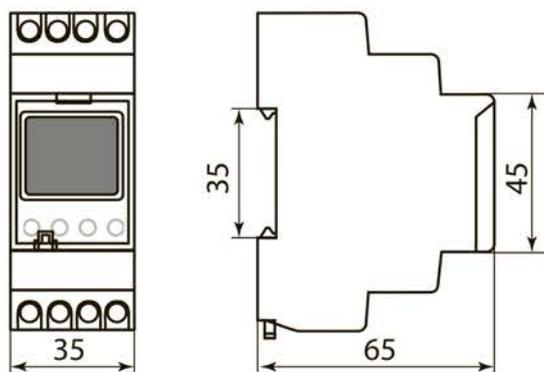
Рисунок 1. Габаритные и установочные размеры реле, мм
