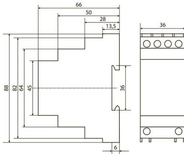
Рисунок 2. Габаритные и установочные размеры трансформаторов, мм
