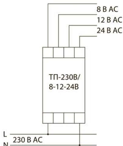
Рисунок 3. Схема подключения трансформатора ТП-230В/8-12-24В к сети
