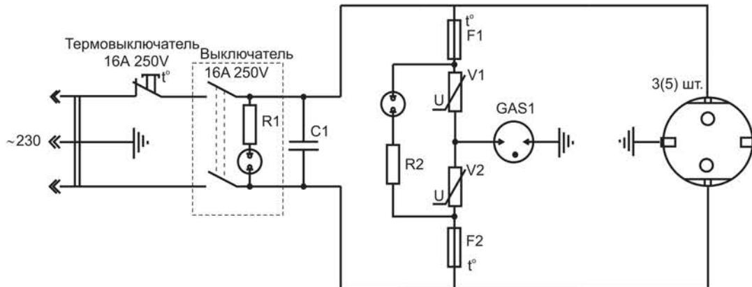
Рисунок 3 – схема фильтра
