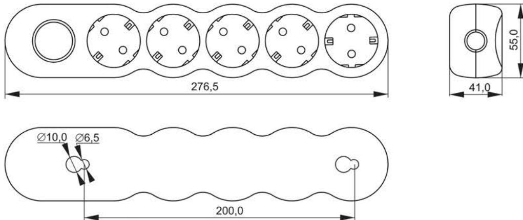
Рисунок 4 – Колодка удлинителя Y05B
