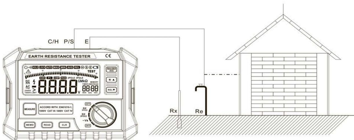
2. Измерение напряжения заземления.
