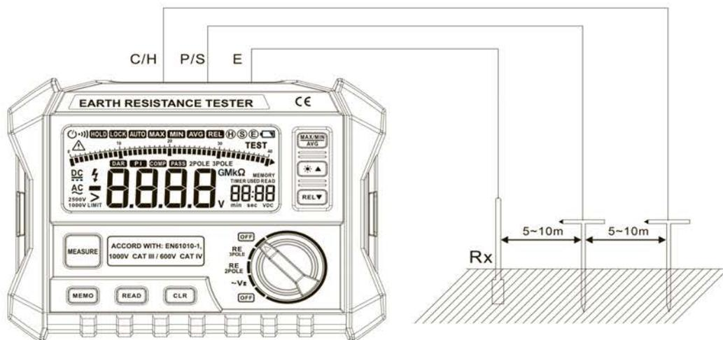
2. Установите вспомогательные заземляющие шины **Р**, **С** вдоль прямой линии как можно глубже в землю таким образом, чтобы между ними было расстояние 5-10 метров. Подсоедините измерительные провода (черный, красный и зеленый) к гнездам **Е**, **Р**, **С**. Противоположные концы измерительных проводов соедините с измеряемым объектом, вспомогательной шиной **Р** и вспомогательной шиной **С**.
