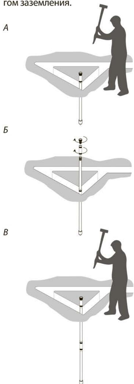
Рисунок 4. Этапы монтажа очага заземления
