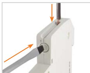
ЛСК-47 имеет безвинтовую конструкцию. Для ввода проводника надавить на толкатель пружины.
