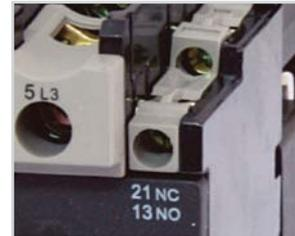
Контакторы на ток нагрузки до 40 А имеют один дополнительный контакт (замыкающий или размыкающий), контакторы на ток нагрузки свыше 40 А имеют два дополнительных контакта (замыкающий и размыкающий).
