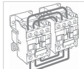
Возможность получения реверсивного варианта с использованием механизма блокировки.
