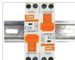
Выключатели ВА47-29 **могут устанавливаться в любом положении** без изменения их номинальных характеристик. Подвод питающей линии может производиться как через верхние, так и через нижние клеммы без нарушения работоспособности автомата.
