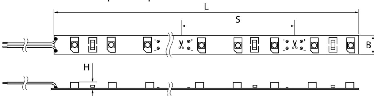
*Рис. 1 Лента светодиодная*
