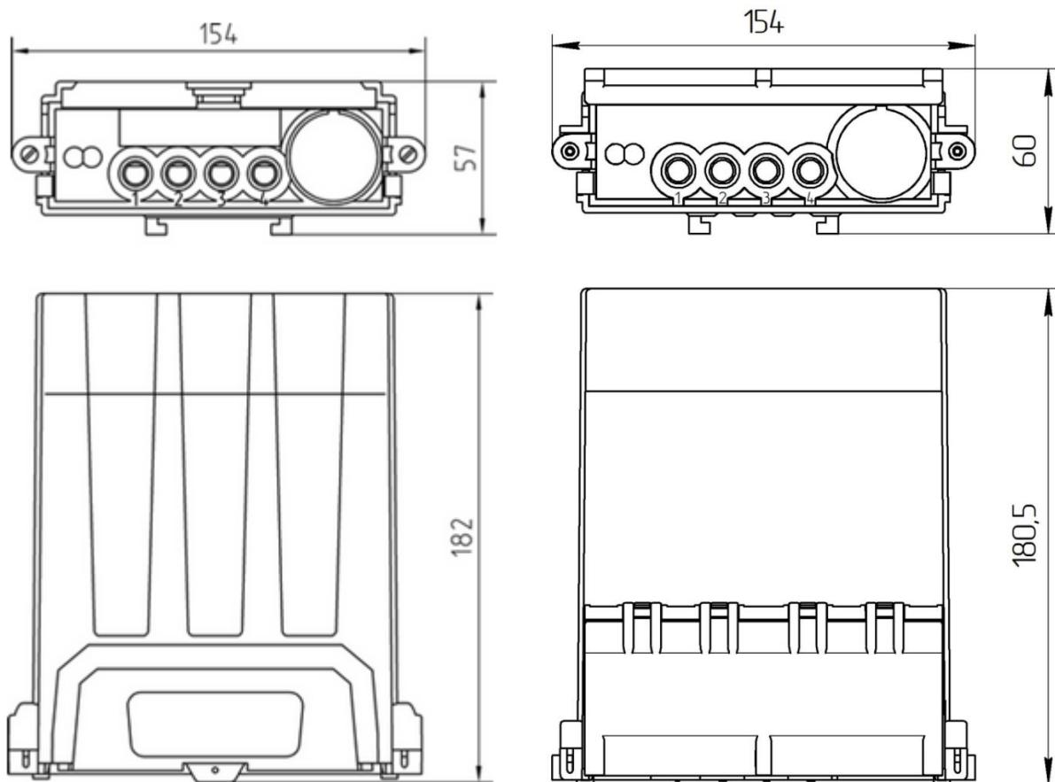
**Рисунок А.2 – Габаритный чертеж счетчика «Меркурий 208»
