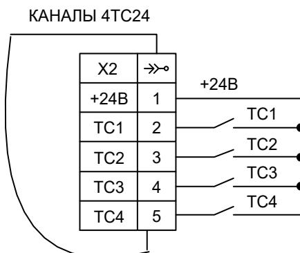
**Рисунок Б.14 – Схема подключения дискретных выходов счетчика «Меркурий 234» с функциями телемеханики**
