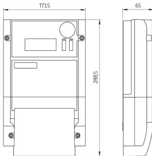
**Рисунок А.3 – Габаритный чертеж счетчика «Меркурий 234»
