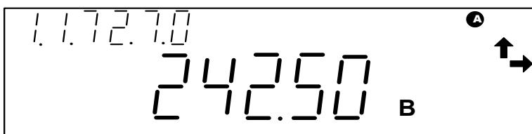
**Рисунок 5.11 – Отображение значения напряжения по фазе А**
