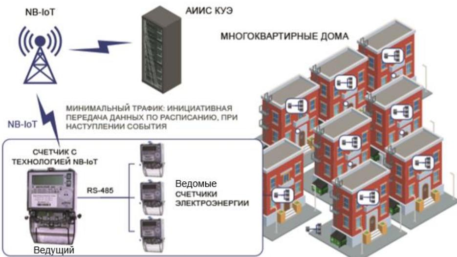
**Рисунок 4.4 – Схема работы счетчика NB-IOT в составе АИИС КУЭ**
