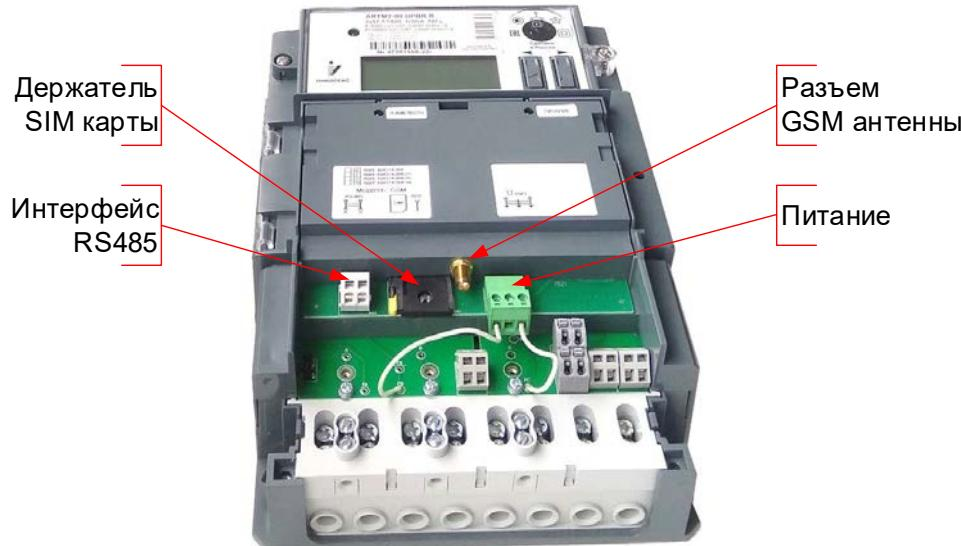
**Рисунок 5.6 – Вид счетчика «Меркурий 234» с модулем GSM
