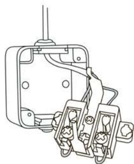
3.5. Затянутые провода вставить в контакты. Затянуть винты клемм. Установить механизм розетки в корпус.
