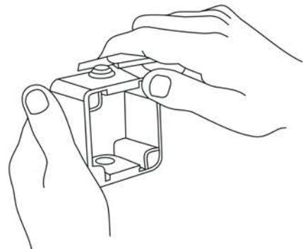
3.3. Аккуратно срезать верх сальника (при необходимости снять его) в соответствии с диаметром кабеля.
