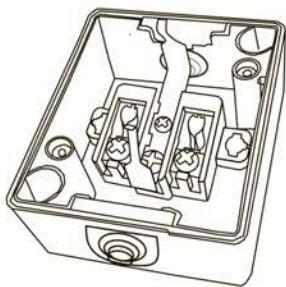
3.2. Снять механизм розетки, поддев его лезвием отвертки.
