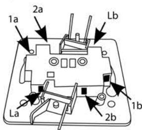
2.3. Присоединить предварительно зачищенные проводники, согласно схемам приведенным в разделе.
