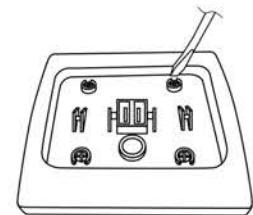
2.2. Выкрутив винты, снять верхнюю часть механизма.
