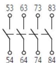
Рисунок Б.7 - Приставки контактные типов: ПКЛ-40, ПКЛ-М40
