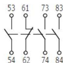
Рисунок Б.9 - Приставки контактные типов: ПКЛ-31, ПКЛ-М31
