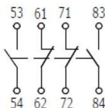
Рисунок Б.5 - Приставки контактные типов: ПКЛ-22, ПКЛ-М22
