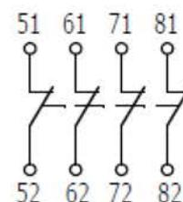
Рисунок Б.6 - Приставки контактные типов: ПКЛ-04, ПКЛ-М04
