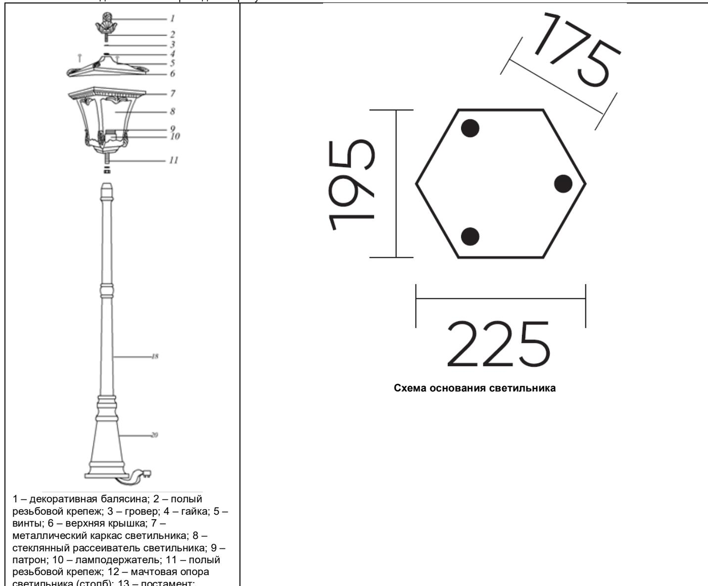
1 – декоративная балюсина; 2 – полый резьбовой крепеж; 3 – гровер; 4 – гайка; 5 – винты; 6 – верхняя крышка; 7 – металлический каркас светильника; 8 – стеклянный рассеиватель светильника; 9 – патрон; 10 – ламподержатель; 11 – полый резьбовой крепеж; 12 – мачтовая опора светильника (столб); 13 – постамент;
