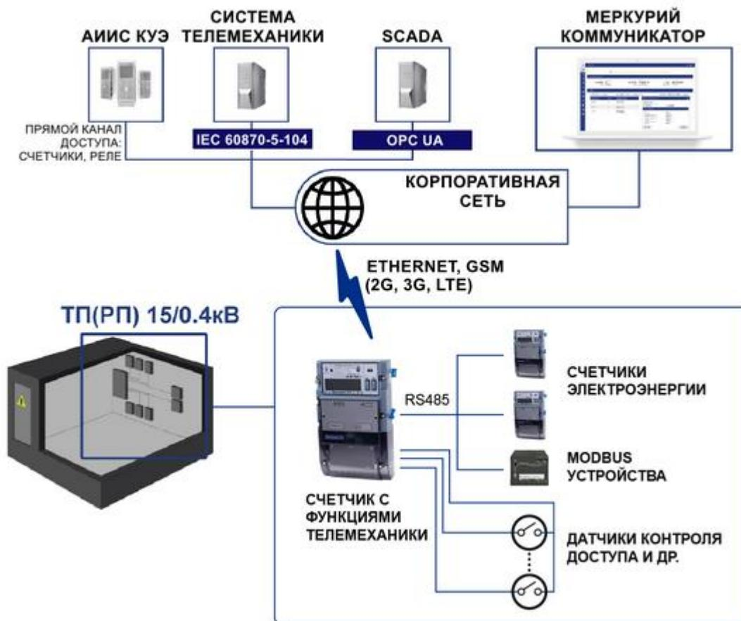
**Рисунок 4.3 – Схема работы в составе автоматизированных систем**
