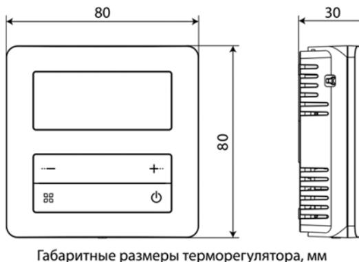
Габаритные размеры терморегулятора, мм
