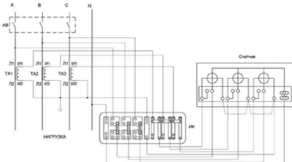
Рисунок 1 - Схема подключения коробок
