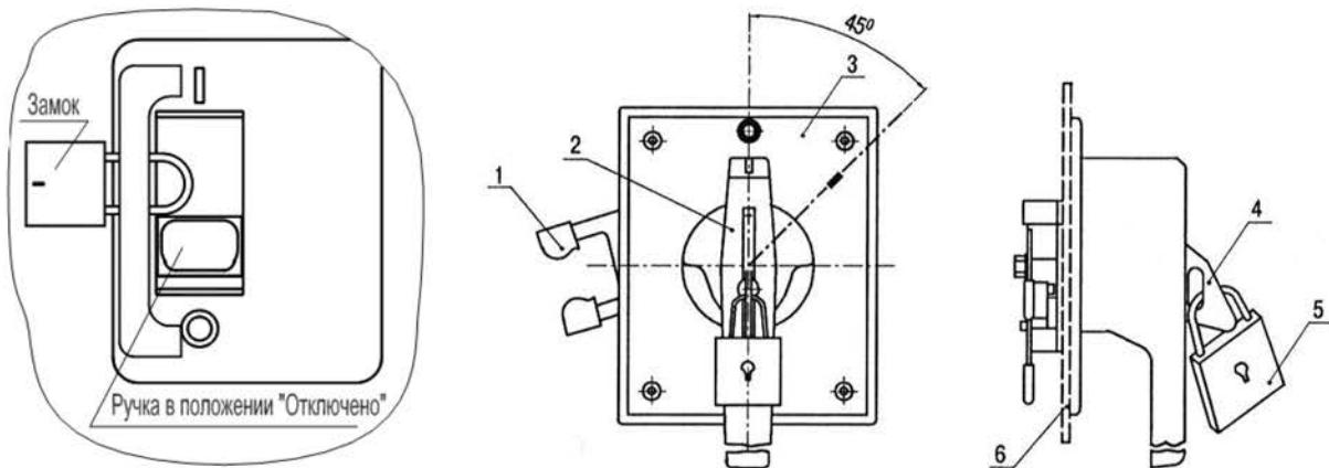
а) выключателей стационарного исполнения, б) выключателей с ручным дистанционным приводом (1 – проводок привода, 2 – рукоятка, 3 – основание, 4 – пластина, 5 – замок, 6 – дверь распределительного устройства).
