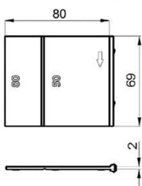
**Рисунок Б.4 – Габаритные размеры межполюсных перегородок**
