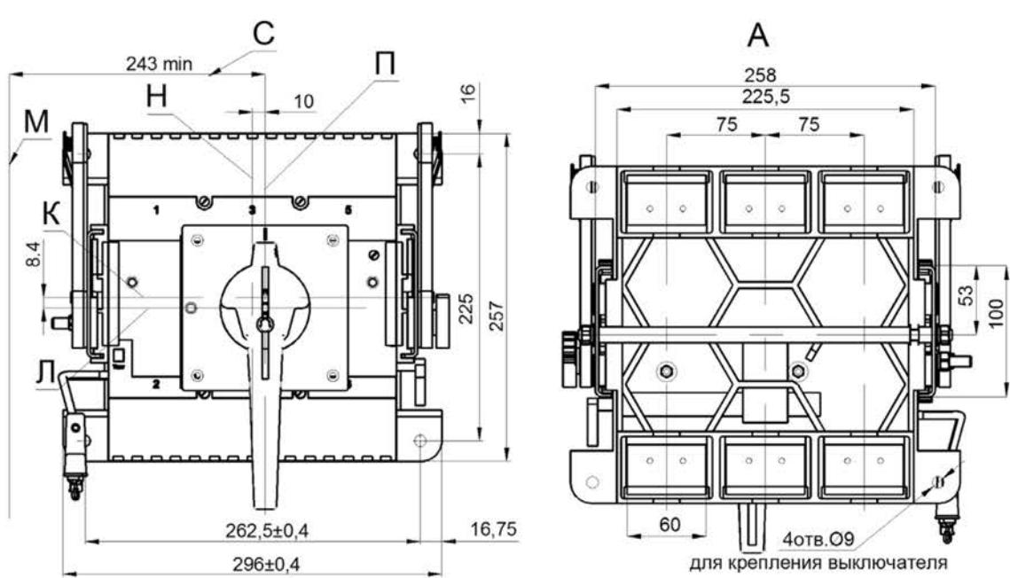
**Рисунок Б.6** – Выключатель выдвижного исполнения с ручным дистанционным приводом: а) выключатель ВА57-39-XXXX50; б) выключатель ВА57-39-XXXX51
