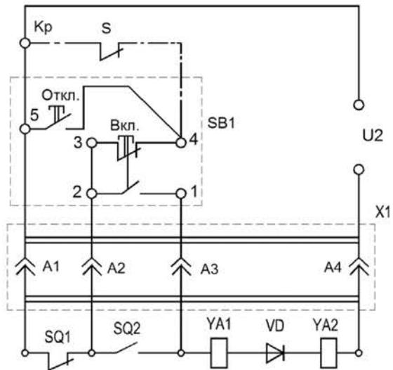
**Рисунок В.7 – Электрическая принципиальная схема привода электромагнитного**
