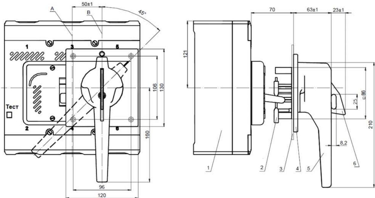
**Рисунок Б.3 – Выключатель с ручным дистанционным приводом для оперирования через дверь распределительного устройства:** А – вертикальная ось выключателя; В – вертикальная ось ручного дистанционного привода. 1 – выключатель; 2 – поводок привода; 3 – дверь распределительного устройства; 4 – основание привода; 5 – рукоятка привода; 6 – запирающее устройство.
