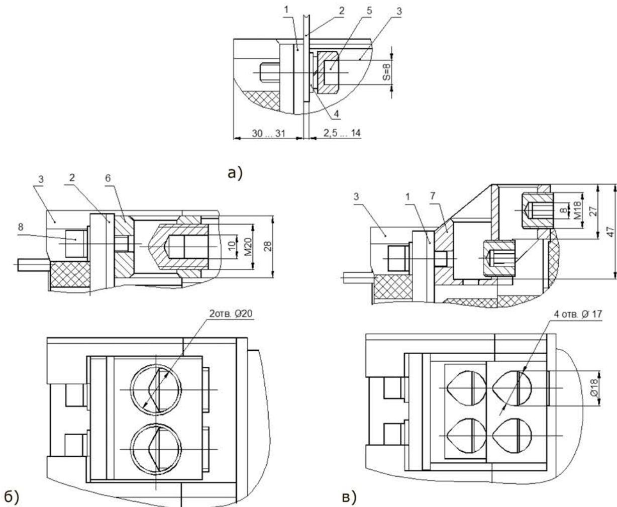
а) присоединение шинами или жилами кабеля с кабельным наконечником,
