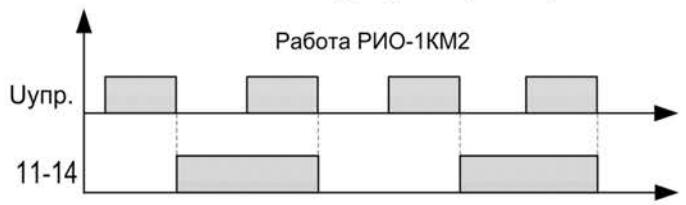
Все модели реле замыкают контакт реле при нулевом сетевом напряжении (переходе сетевого напряжения через ноль, технология «zero sync»™).
