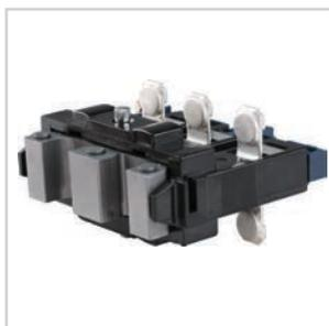
Контактор обладает повышенной износостойкостью и малым значением переходного сопротивления контактов за счет применения контактных деталей на основе серебра и покрытий на контактной группе.
