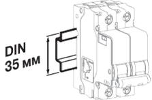
Крепление на DIN-рейку шириной 35 мм
