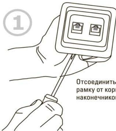
Отсоединить крышку и деко-ративную рамку от корпуса розетки, поддев наконечником плоской отвертки.
