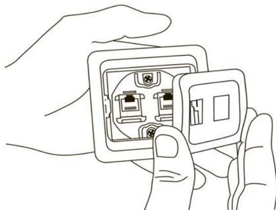
Отсоединить разъем розетки от корпуса отведением защелок разъемов на лицевой стороне, и вдавливания их во внутрь.
