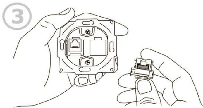
Подсоединить защищенные телефонные провода к клеммной колодке, затянуть винты, подсоединить провода интернет-кабеля используя специальный нож.
