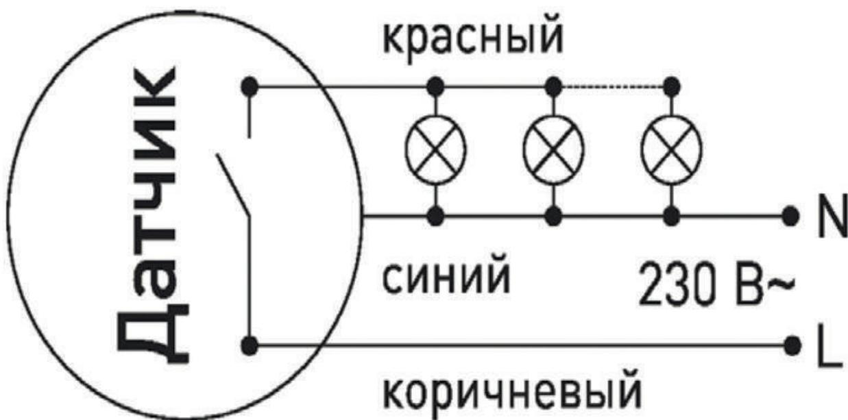
Кроме того, на некоторых датчиках предусмотрена 4 клемма для подключения заземления РЕ.
