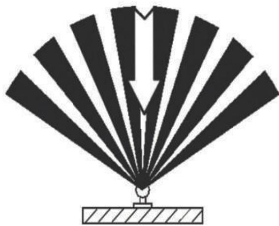
При выборе места установки следует исключить из зоны обнаружения датчика объекты, которые могут приводить к его ошибочным срабатываниям. Для этого необходимо избегать установки датчика вблизи зон температурного возмущения (кондиционер, отопление) и вентиляторов.
