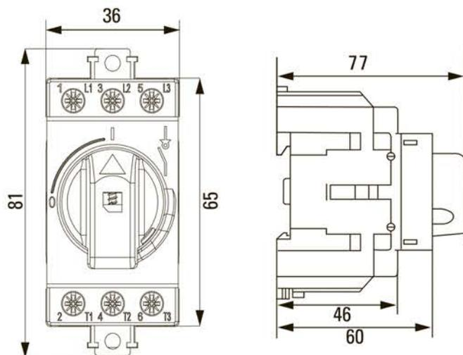
Рис. 1а Габаритные размеры рубильника MS 16-40А
