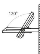
4. Закрепите болты кронштейна для фиксации прожектора
