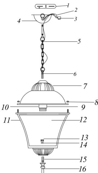
1 – крепежный элемент; 2 – заземляющий провод; 3 – клеммная колодка; 4 – чаша; 5 – цепь подвеса; 6 – винтовой крепеж; 7 – верхняя крышка; 8 – резьбовое крепление; 9 – патрон; 10 – ламподержатель; 11 – каркас; 12 – стеклянный рассеиватель; 13 – гайка; 14 – гровер; 15 – резьбовое крепление; 16 – балансина.
