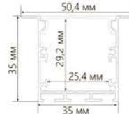
**CAB255** - встраиваемый профиль для создания световых линий на подвесных потолках любого типа. Подсветка в виде линий на потолке выглядит эффектно и стильно, а также практична и экономична в использовании. Вариантов исполнения великое множество: линии могут быть прямыми, изогнутыми, идти от одной стены к другой, пересекаться или образовывать замкнутый контур.
