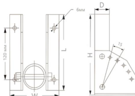
Кронштейн стеновой с переменным углом ДС-1 ТМ Feron предназначен для крепления консольных светильников к стене.
