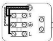
Коричневый провод – L (фаза); синий провод – N (ноль); желто-зелёный – заземление
