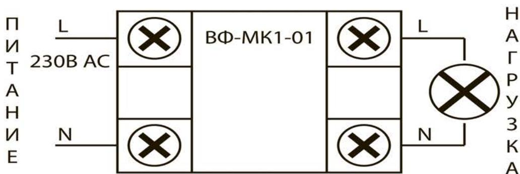
Рисунок 2. Схема подключения реле ВФ-МК1-01 к электрической сети
