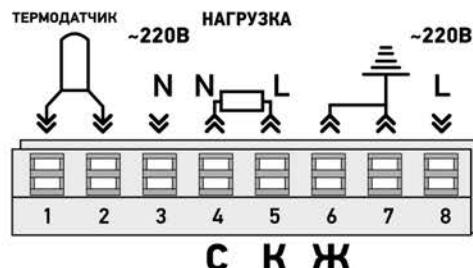
Порядок подключения клемм
