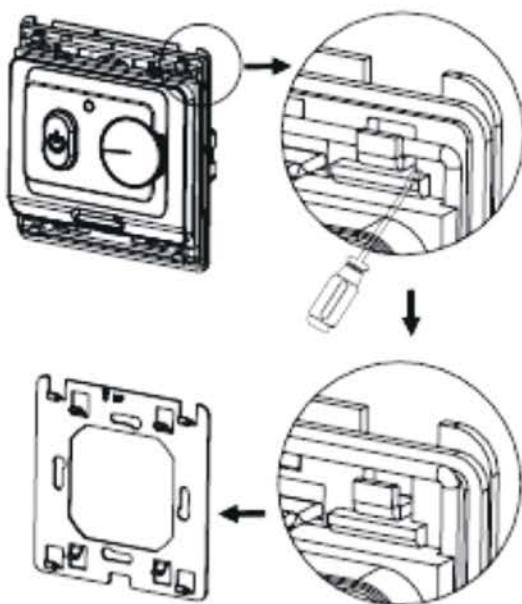
3. Установите заднюю панель на монтажную коробку в стене с помощью отвертки.
