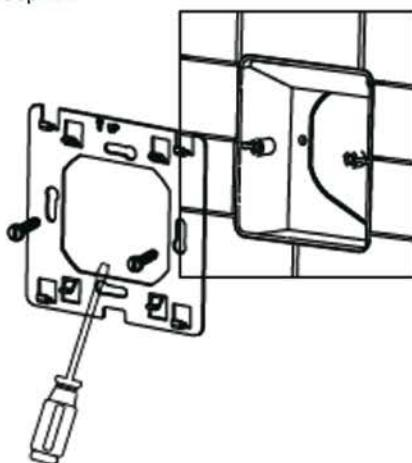
4. После подключения проводов (см. схему ниже), окончательно установите терморегулятор на крепления на задней панели и поставьте на место крышку и рамку.
