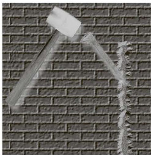
3. Подготовить в стене канал для укладки силового шнура нагревательного мата и трубки термодатчика (рис. 3);
