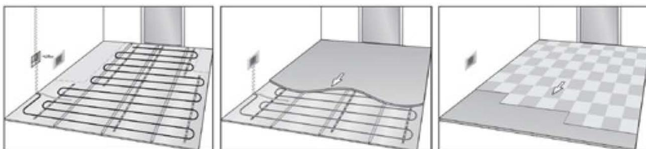
1. Подготовьте в стене место для установки терморегулятора.
