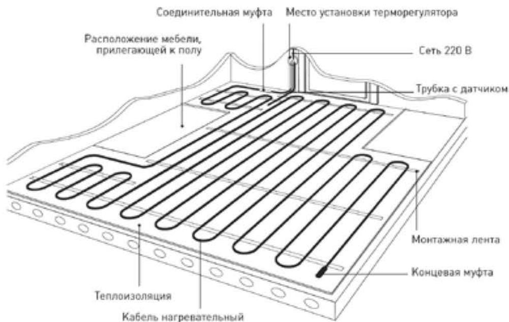
Датчик температуры пола устанавливается в монтажной трубке, в полу, на расстоянии 50-60 см от стены, на которой расположен терморегулятор. Для точного измерения температуры, разместите трубку с датчиком на равном расстоянии между витками кабеля.
