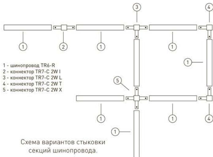
Схема вариантовстыковки секций шинопровода.
