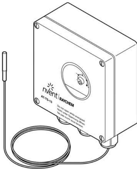
Электронные термостаты с регулированием по температуре обогреваемой поверхности nVent RAYCHEM AT-TS-13 и AT-TS-14 предназначены для использования в нормальных (невзрывоопасных) зонах. Через окошко на крышке прибора можно проверить уставку температуры и состояние термостата, указываемое светодиодами (включение обогрева и неполадки датчика температуры).
