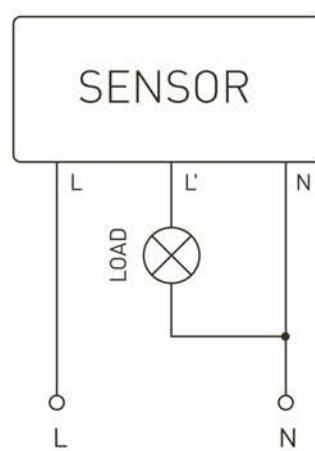
Рисунок 3. Схема подключения.
