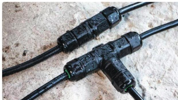
Герметичные кабельные коннекторы Navigator серии NTB-IP68 предназначены для соединения и распределения электрических проводников, требующих обеспечения полной герметичности электрической цепи. Благодаря степени защиты от влаги и пыли IP68 коннекторы могут использоваться под водой и под землей без угрозы потери качества соединения. Основной областью применения являются промышленное и уличное освещение.
