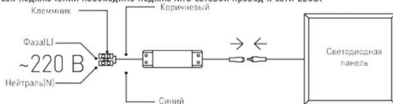
Рис.1. Подключение блока питания.
